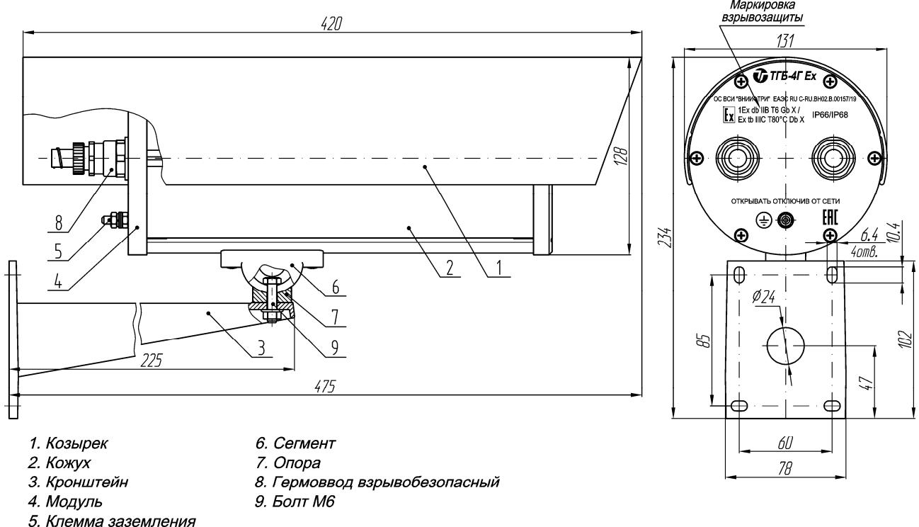
Маркировка взрывозащиты: для ТГБ-4Г Ex - 1Ex db IIB T6 Gb X / Ex tb IIIC T80°C Db X
