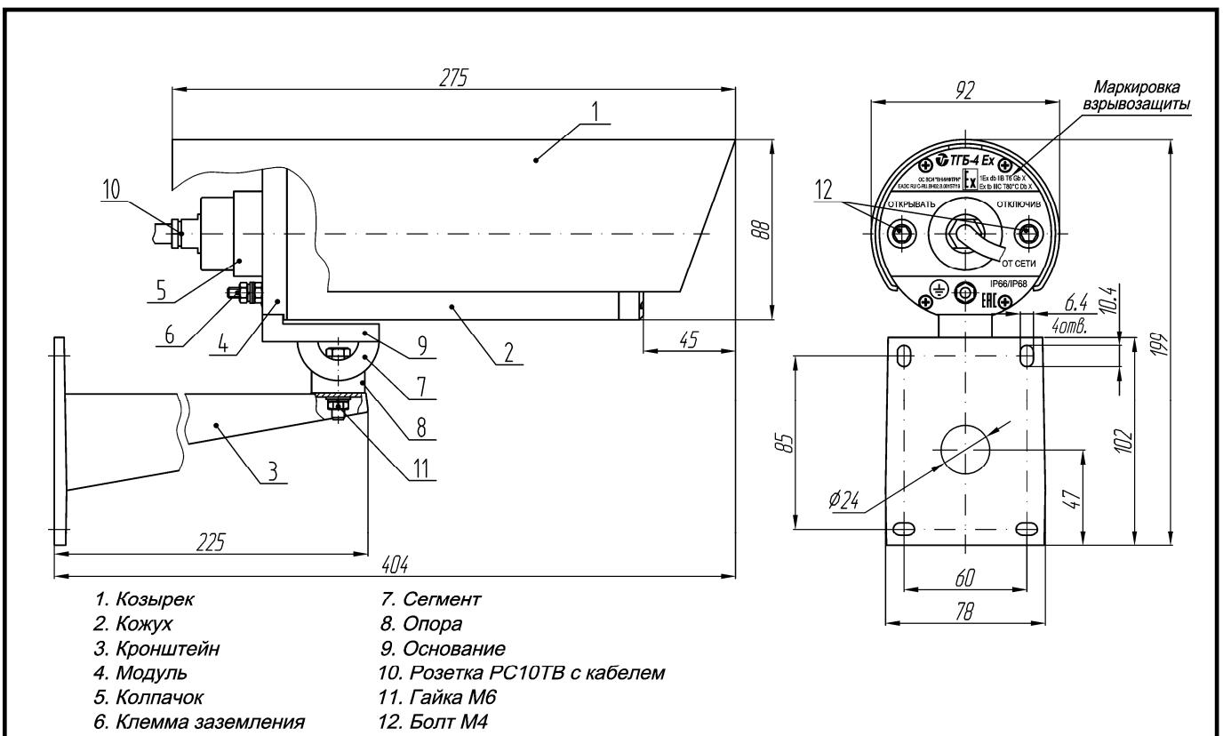
Маркировка взрывозащиты: для ТГБ-4 Ex - 1Ex db IIB T6 Gb X / Ex tb IIIC T80°C Db X
