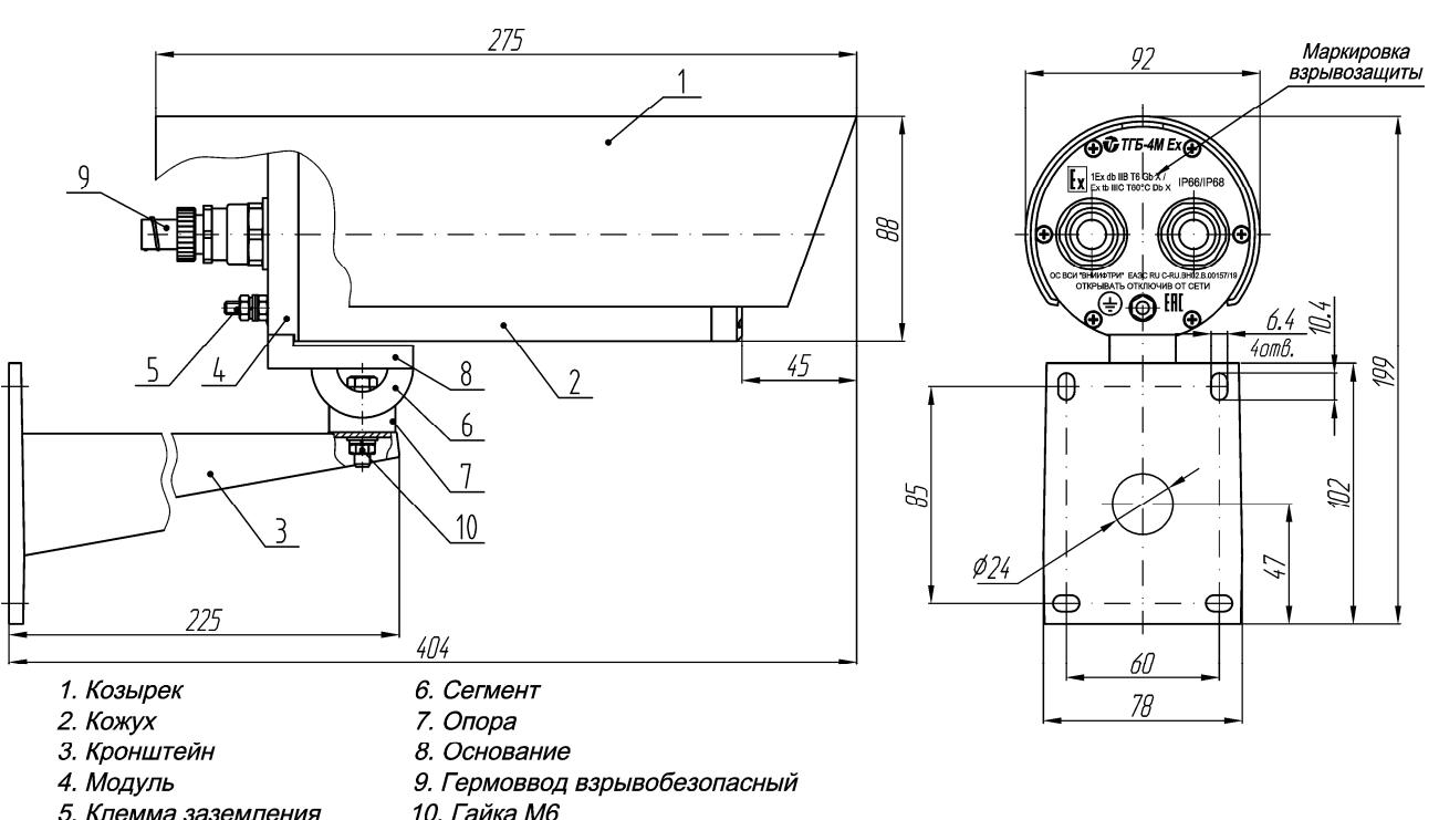
Маркировка взрывозащиты: для ТГБ-4M Ex - 1Ex db IIB T6 Gb X / Ex tb IIIC T80°C Db X
