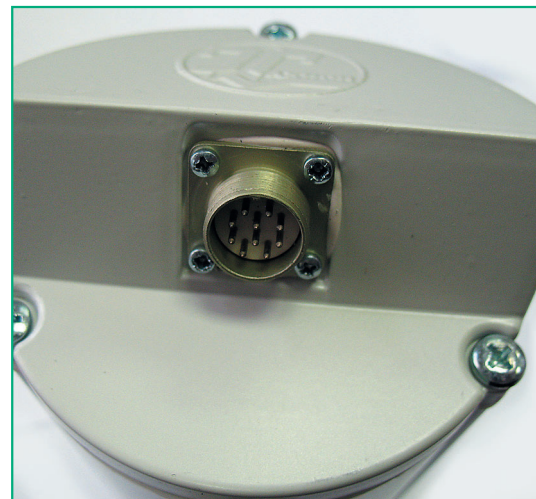
Рис. 4. Задняя стенка бокса с разъемом РСГ-10 – вилка
