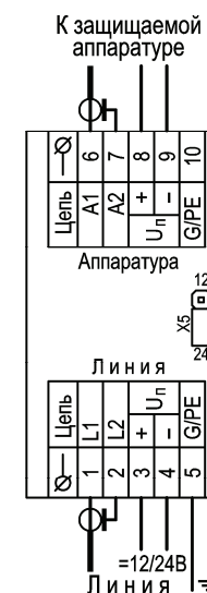
Рис. 3 Схема подключения для несимметричных линий на основе коаксиального кабеля
